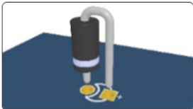
Diode(Vertical). Notice the polarity
